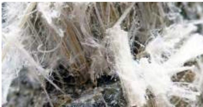
**La fibre minérale d'amiante** a beaucoup été utilisée dans les constructions avant les années 90 grâce à ses propriétés ignifuges, isolantes et insonorisantes. C'est à partir de 1990 que **ce matériau a été interdit** dans la construction de bâtiments en Suisse. En effet, ces fibres peuvent être absorbées par voie respiratoire causant des pathologies mortelles.
